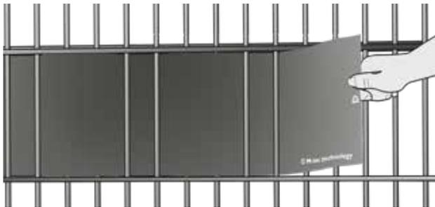
Die Streifen sind markiert, so dass Sie nach Reihenfolge einfach und schnell einflechten können
